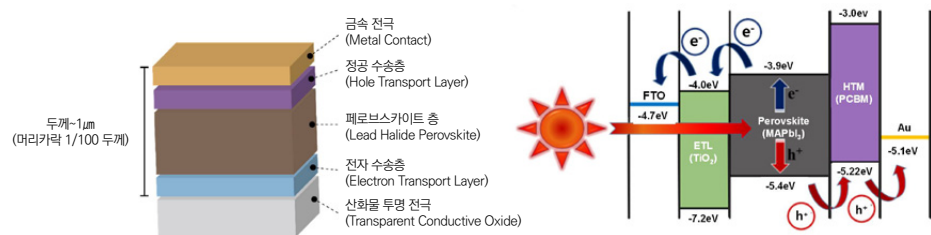
그림 6 페로브스카이트 태양전지 구조 및 작동 원리
