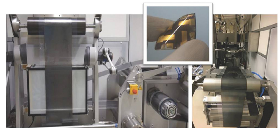
그림 48 슬롯-다이 코팅을 활용한 대면적 페로브스카이트 박막 형성 연구
